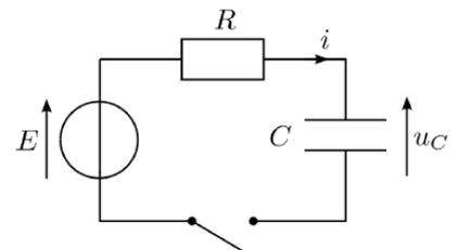
**Éléments de réponse :** Au bout d'un temps infini, le régime permanent continu est atteint, et le condensateur se comporte comme un interrupteur ouvert. En effet, en convention récepteur, sa caractéristique est  $i = C \frac{du_c}{dt}$ , soit pour une tension  $u_{c,\infty} = cte$ ,  $i_\infty = 0$  : quelle que soit la valeur de la tension, l'intensité est nulle.
