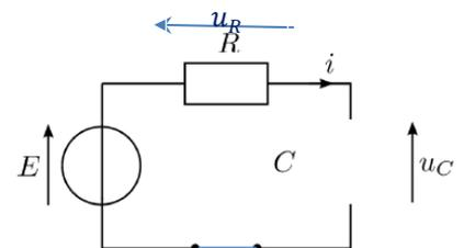
Or  $E \stackrel{\substack{\text{Loi} \\ \text{des mailles}}}{=} u_c + u_R$  soit  $E = u_c(0^+) + u_R(0^+) = u_R(0^+) \stackrel{\substack{\text{caractéristique} \\ \text{de R}}}{=} R i(0^+)$  d'où  $i(0^+) = \frac{E}{R}$
