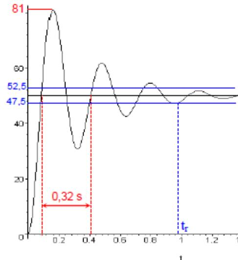
7 - Temps de réponse : la réponse doit être comprise entre  $0,95 \cdot 50 = 47,5$  et  $1,05 \cdot 50 = 52,5$  d'où  $\boxed{t_r \approx 1 \text{ s}}$
