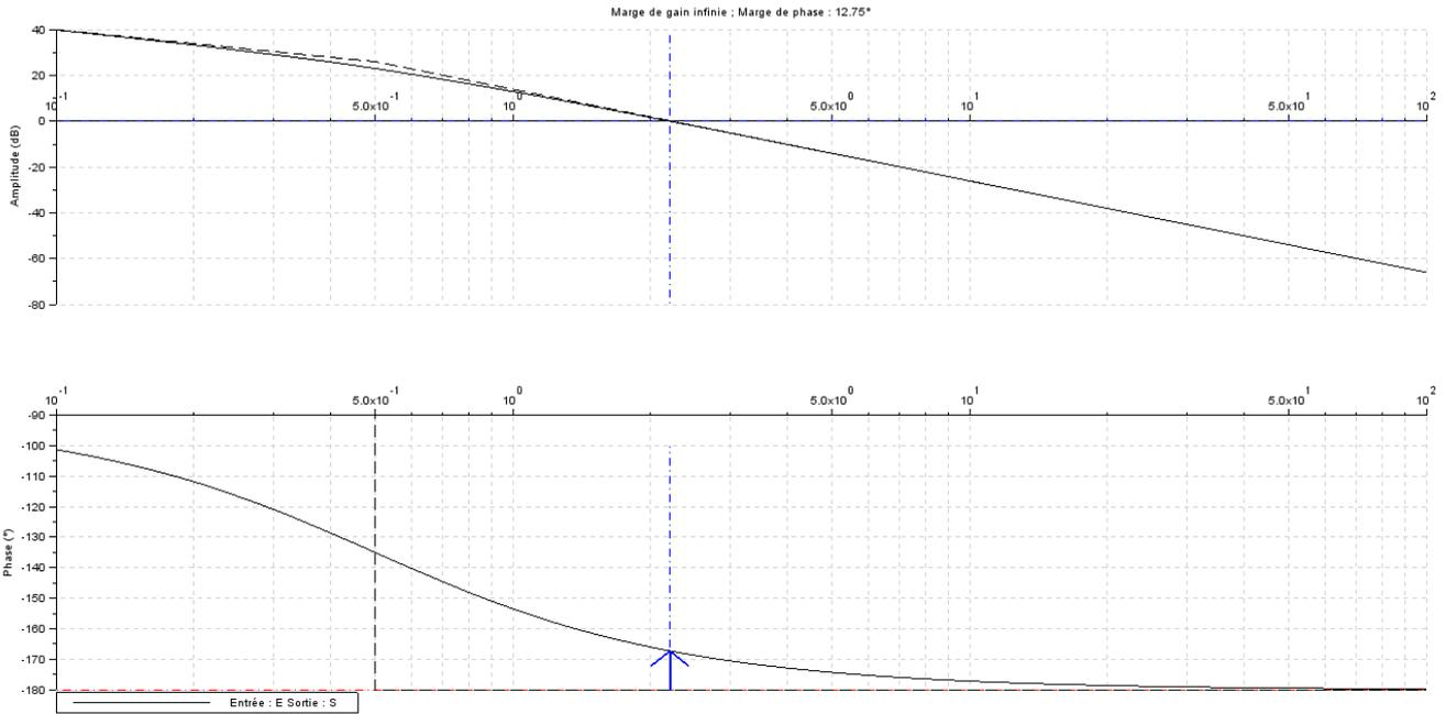
**Q3** – pas assez de phase. Système trop oscillant donc lent. Correcteur à avance de phase.
