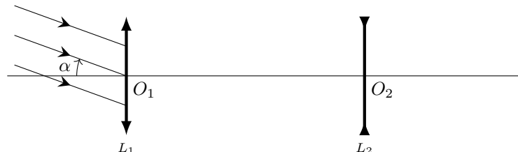
Figure 2 - Schéma optique de la lunette de Galilée
