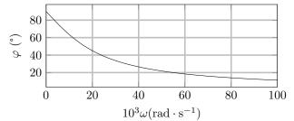
**Q.4** On cherche les asymptotes en basses fréquences et hautes fréquences pour  $G_{\text{dB}} = 20 \log(G(\omega))$  et  $\varphi$ .
