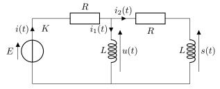
Par continuité on a  $i_1(t=0^+)=0$  et  $i_2(t=0^+)=0$  car les bobines sont déchargées.
