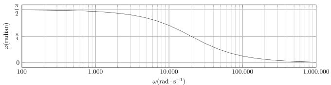
**Q.5** On calcule l'impédance équivalente  $\underline{Z}_{\rm eq}$  :  $\frac{1}{\underline{Z}_{\rm eq}}=\frac{1}{R}+jC_0\omega+\frac{1}{R_0}$
