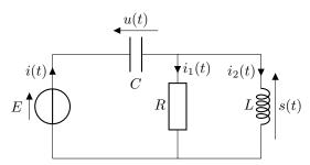
Par continuité on a :  $u(t=0^+)=0$  et  $i_2(t=0^+)=0$  car le condensateur et la bobine sont déchargés.
