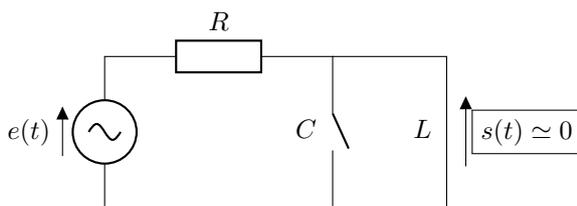
Schéma électrique équivalent en HF :
