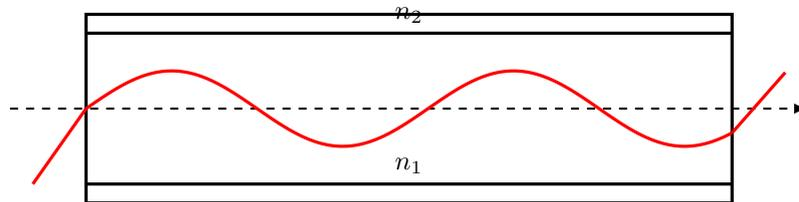
**Q.12** Il y a un étalement car les vitesses de propagation dépendent de l'indice même si la longueur parcourue est la même : le **chemin optique** change.
