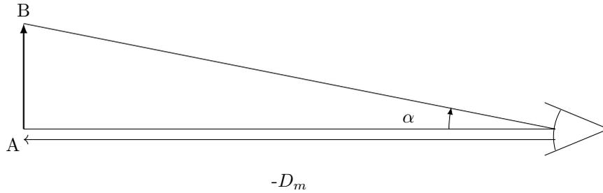
Dans les conditions de Gauss, on a  $\alpha \ll 1$  et  $\alpha' \ll 1$  on a donc d'après le schéma sur le document Annexe :  $\tan(\alpha') = \frac{\overline{A_1B_1}}{-f'_2} \approx \alpha'$ . D'après le schéma de la question précédente, on a  $\tan(\alpha) = \frac{\overline{AB}}{-D_m} \approx \alpha$ .
