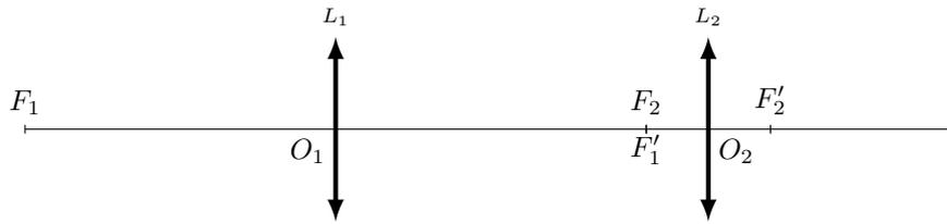
Un tel système optique est appelé système afocal et ne possède pas de foyers.
