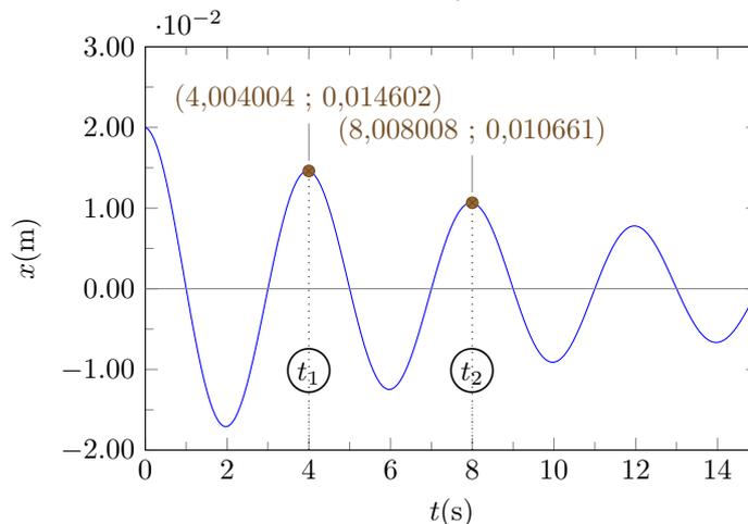
**Figure 3** - Relevé du déplacement horizontal  $x$  (en m) de la plateforme de masse  $m = 110$  tonnes en fonction du temps  $t$  (en s). Les deux temps  $t_1$  et  $t_2$  mentionnés en question **Q.14** sont indiqués.
