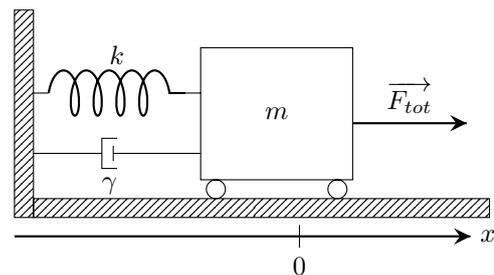
**Figure 2** - Système masse ( $m$ ), ressort ( $k$ ), amortisseur ( $\gamma$ ) et excitation externe ( $\vec{F}_{\text{exc}}$ ).
