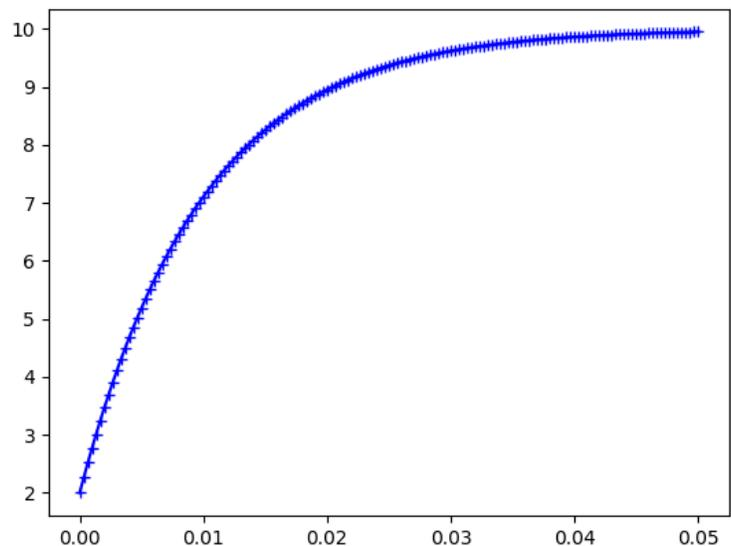
Ci-contre, la ligne polygonale (en bleu) approchant la solution exacte du problème de Cauchy (avec  $n = 150$ ).
