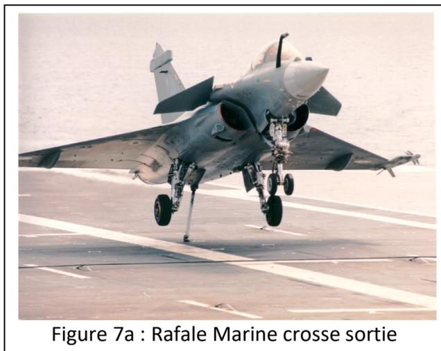
Figure 7a : Rafale Marine crose sortie
