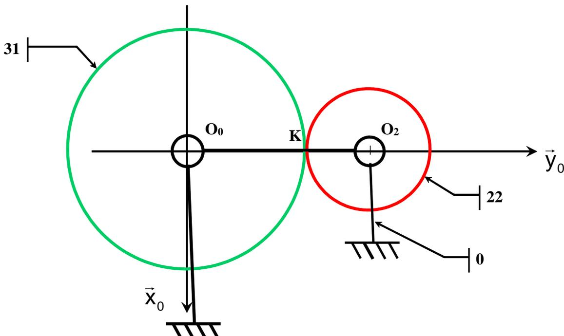
Question 6 : Calculer en fonction des données géométriques du mécanisme, le rapport de réduction du réducteur primaire  $k_{31} = \frac{\omega_{3/0}}{\omega_{1/0}}$ . Effectuer l'application numérique. En déduire  $N_3$ .
