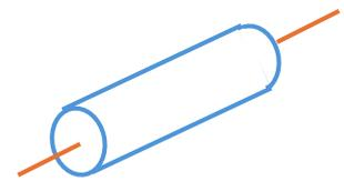
$$\{V(S_i / S_j)\} = \begin{Bmatrix} 0 & 0 \\ 0 & 0 \\ r_{ij} & w_{ij} \end{Bmatrix}_B$$
