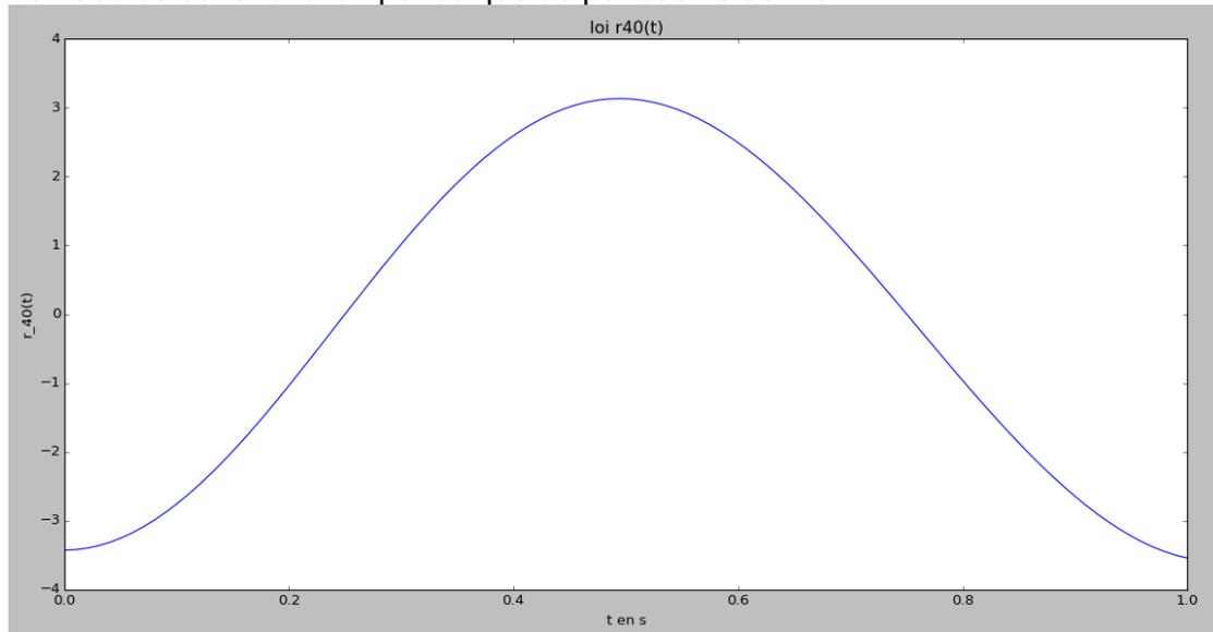
On observe alors un mouvement de rotation à vitesse alternativement positive et négative et correspond à un mouvement en aller et retour dans le produit à mélanger.
