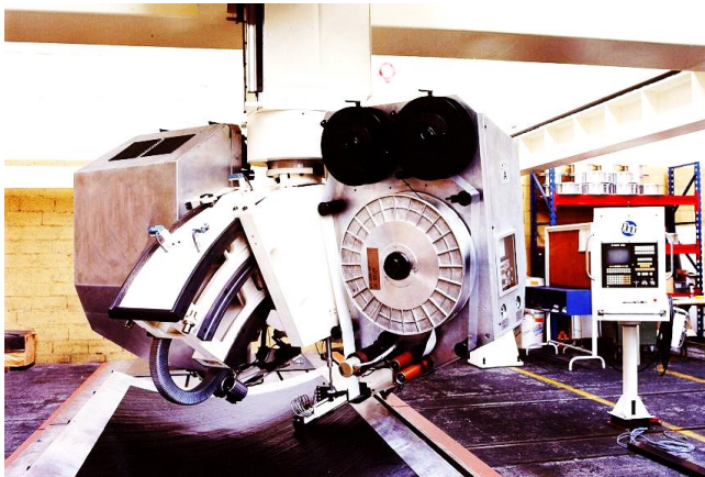
Figure 3 : Tête de dépose en travail
