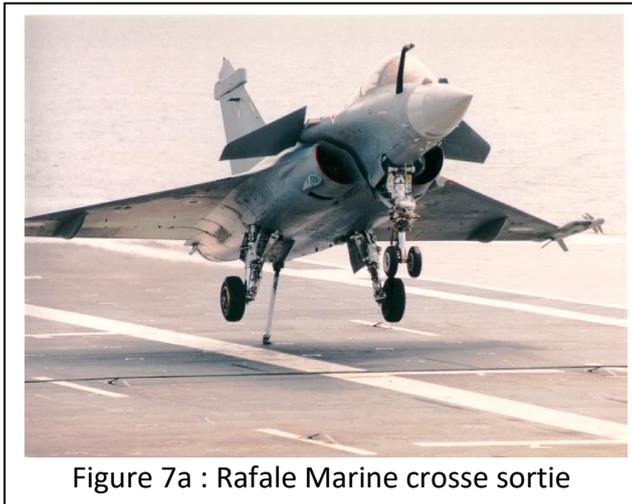
Figure 7a : Rafale Marine crose sortie
