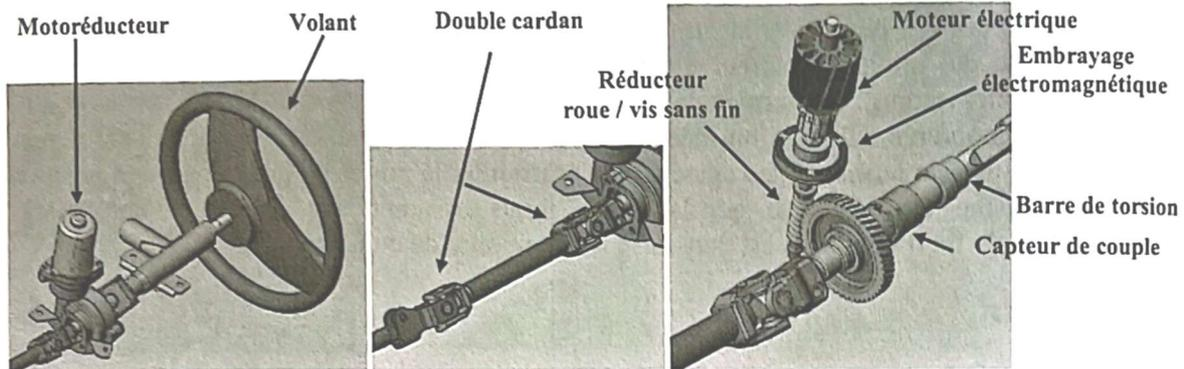
Le système doit assister le conducteur dès la mise en rotation du volant. Un capteur de couple informe le calculateur de l'intensité du couple exercé sur le volant. Le motoréducteur est alors commandé en fonction du couple exercé par l'utilisateur sur le volant mais aussi en fonction de la vitesse du véhicule.
