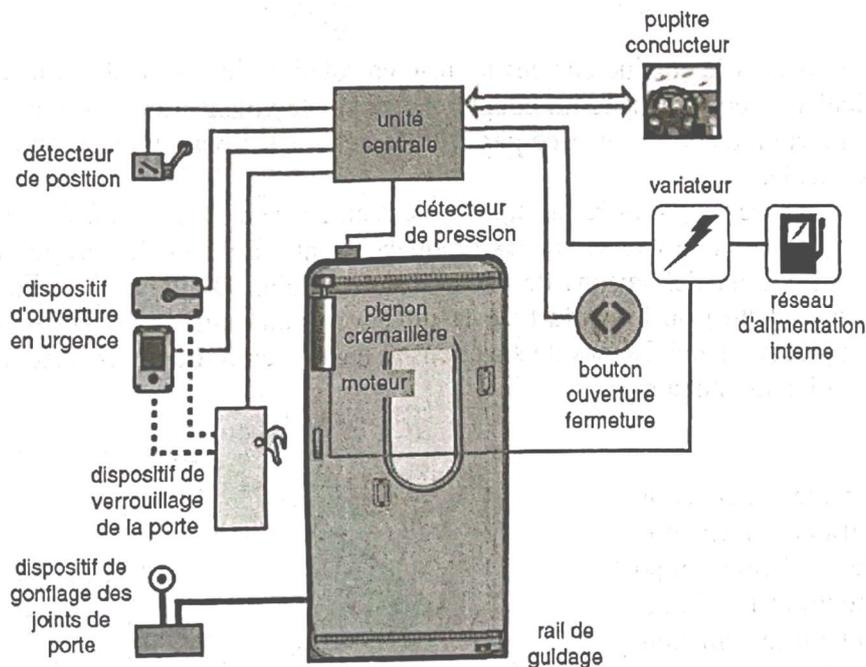
Pour le système « Porte de TGV », construire le schéma topo fonctionnel montrant l'architecture de la chaîne d'information.
