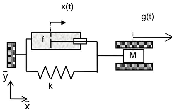
**Système asservi (asservissement de position)** sera représenté par un ensemble d'équations différentielles traduisant les dynamiques des différents composants (actionneurs, capteurs, modulateur, inerties des effecteurs, carte de commande).
