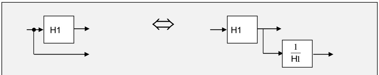
**3.3.4. Déplacement d'un point de prélèvement avant un bloc :**
