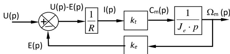
**Question 13. A partir des résultats précédents déterminer la fonction de transfert de l'ensemble du moteur  $H(p) = \frac{\Omega_m(p)}{U(p)}$ . On doit trouver une expression de cette fonction ne dépendant que des constantes et de la variable de Laplace  $p$ . /1pts**
