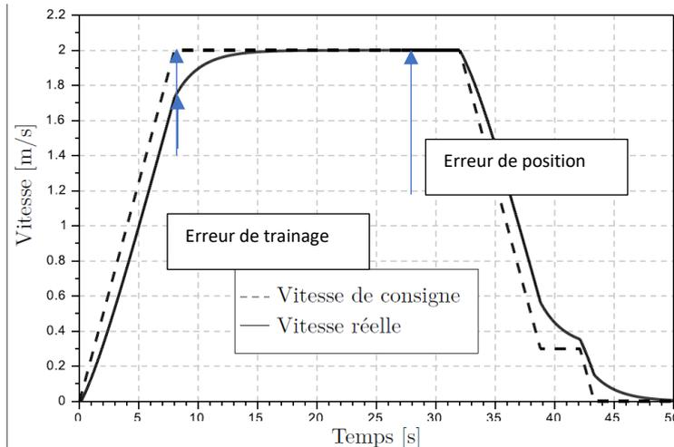
Pour  $t = 8$  s, qui correspond à la fin de la réponse du système soumis à une consigne de type rampe, la valeur de la vitesse simulée est  $v = 1,75$  m/s ce qui correspond à une erreur de trainage de 0,25 m/s environ.
