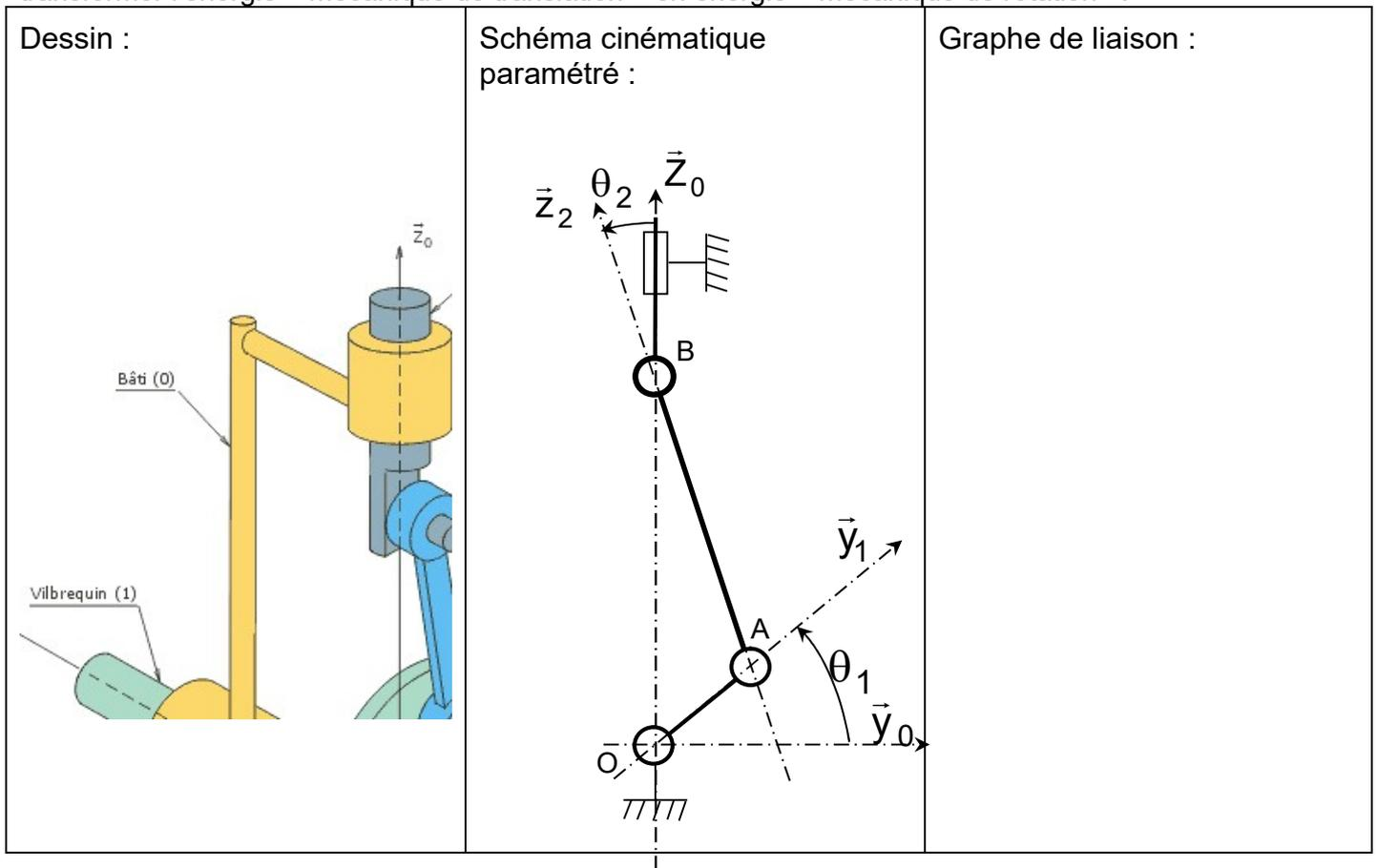
Paramétrage géométrique du mécanisme :
