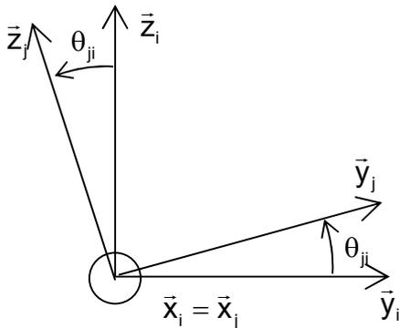
Lorsque  $\theta_{ji}(t) = (\vec{y}_i(t), \vec{y}_j(t)) = (\vec{z}_i(t), \vec{z}_j(t))$  angle orienté entre les 2 vecteurs unitaires de 2 repères associés à 2 solides différents en mouvement l'un par rapport à l'autre pour lesquels  $\vec{x}_i(t) = \vec{x}_j(t)$ .
