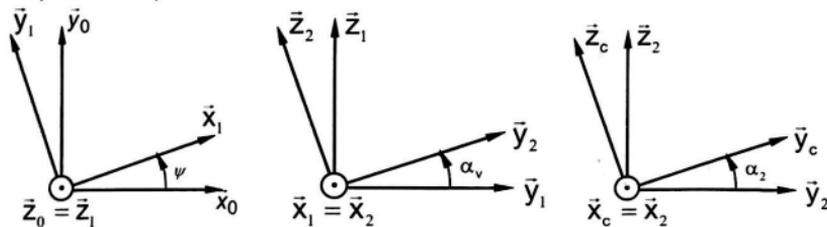
On considère que la traverse tourne autour de  $G$  grâce au mécanisme de pendulation et on paramètre alors la position du passager à l'aide des vecteurs :
