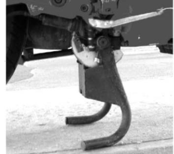
Sur des motos lourdes (300kg et plus) le béquillage électrique est une option proposée. L'objectif est de déterminer les actions transmises par le système de béquillage électrique.
