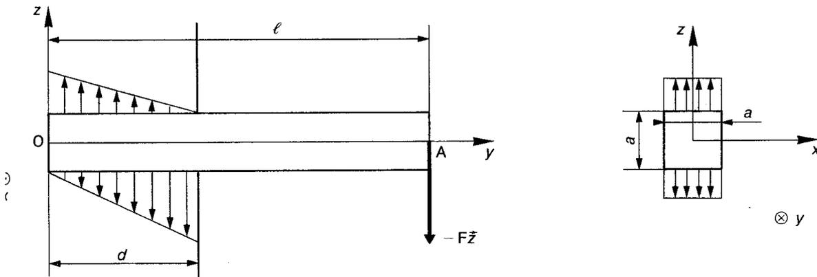
On notera  $p_1$  et  $p_2$  les pressions maximales appliquées par la poutre sur le mur sur les surfaces  $S_1$  et  $S_2$ .
