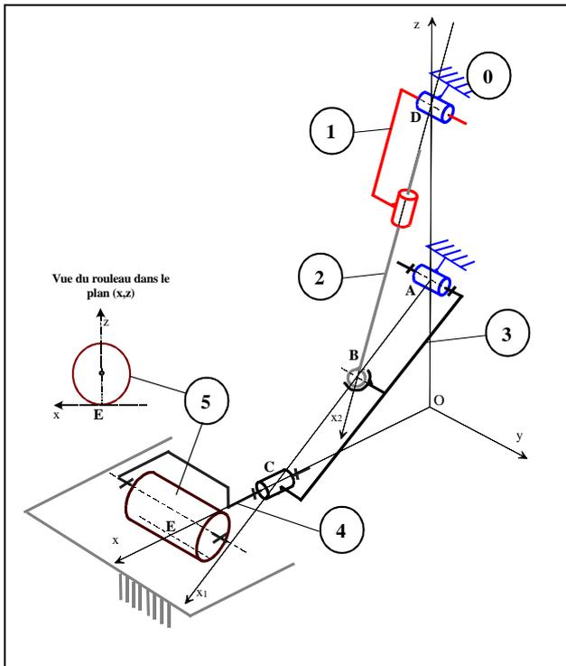
Pour valider le dimensionnement de la liaison pivot glissant on cherche à vérifier que la pression de contact maximale dans cette liaison ne dépasse pas  $p_{lim} = 50N/mm^2$ , pression de contact supportée par la bague autolubrifiée utilisée dans cette liaison dans ces conditions de fonctionnement. La géométrie de la bague est définie par son diamètre intérieur  $d_1$  et sa longueur  $L$  :
