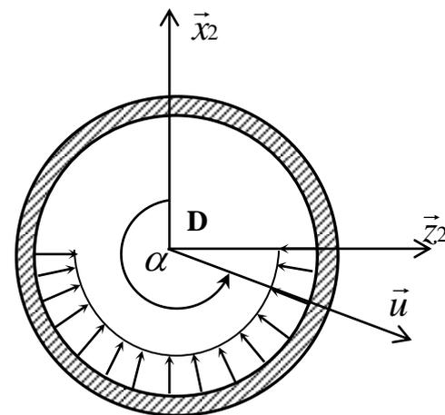
**Question 1 : Déterminer  $p_0$ . Comparer à  $p_{lim} = 50N/mm^2$ .** **Figure 1 : Répartition de pression uniforme**
