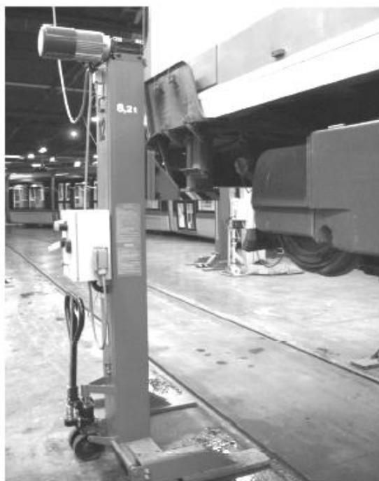
Photo 4 : Colonne d'extrémité en phase de levage
