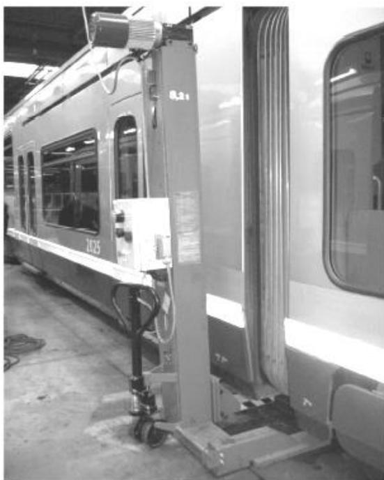
Photo 3 : Mise en place d'une colonne
