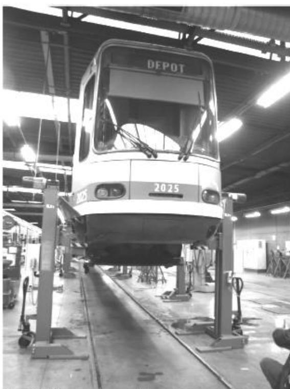
Photo 5 : Tramway en position soulevée
