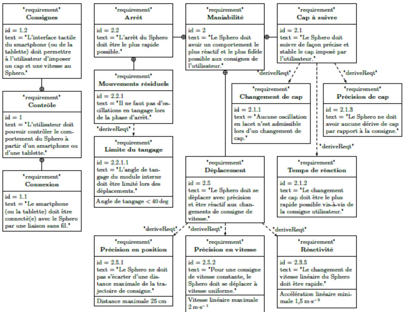
Figure 4 Diagramme des exigences du Sphero
