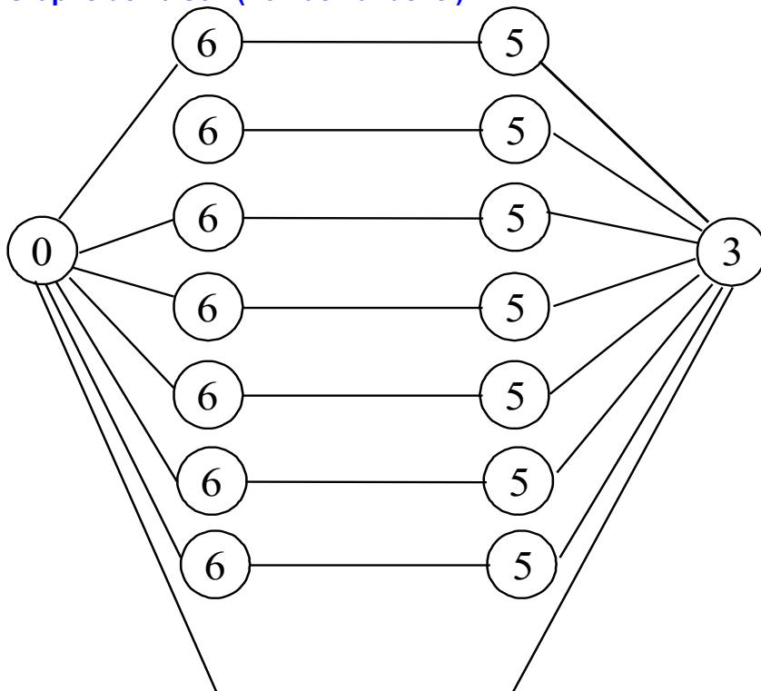
$$\{V\ 3/5\} = \begin{Bmatrix} 0 & 0 \\ q_{35} & v_{35} \\ 0 & 0 \end{Bmatrix} \begin{matrix} \\ \\ \text{dans } (\vec{x}, \vec{y}, \vec{z}) \\ \text{en A ou } O_0 \end{matrix}$$
