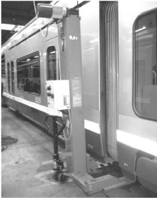
Photo 3 : Mise en place d'une colonne
