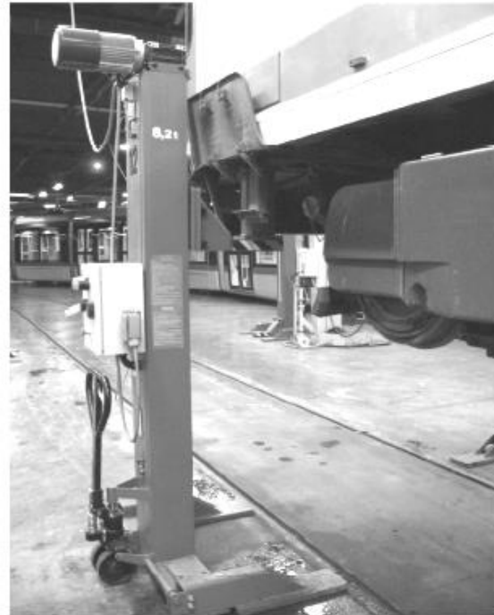
Photo 4 : Colonne d'extrémité en phase de levage
