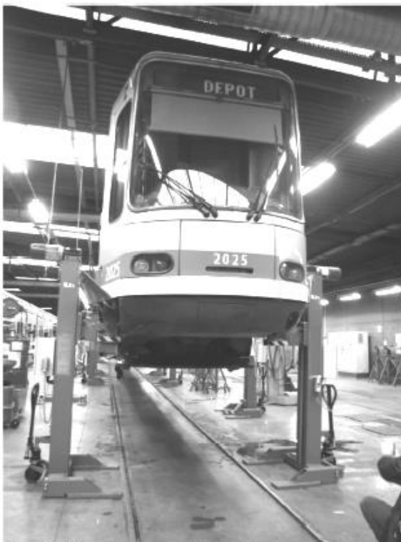
Photo 5 : Tramway en position soulevée
