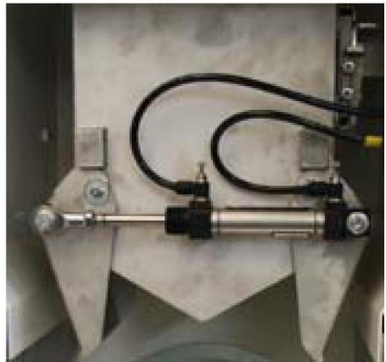
Les deux mâchoires sont en liaison pivot avec la cuve. En position fermée (figure de gauche) on modélise la liaison entre les deux mâchoires par une liaison appui plan. Un seul vérin actionne l'ouverture et la fermeture des mâchoires. La tige du piston du vérin et le corps du vérin sont respectivement en liaison sphérique avec chacune des deux mâchoires.
