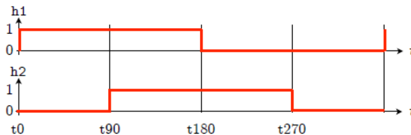
FIGURE 8 – Évolution temporelle des variables associées aux détecteurs à effet Hall lors d'une rotation complète du barillet sur un tour, effectuée à vitesse constante dans le sens positif
