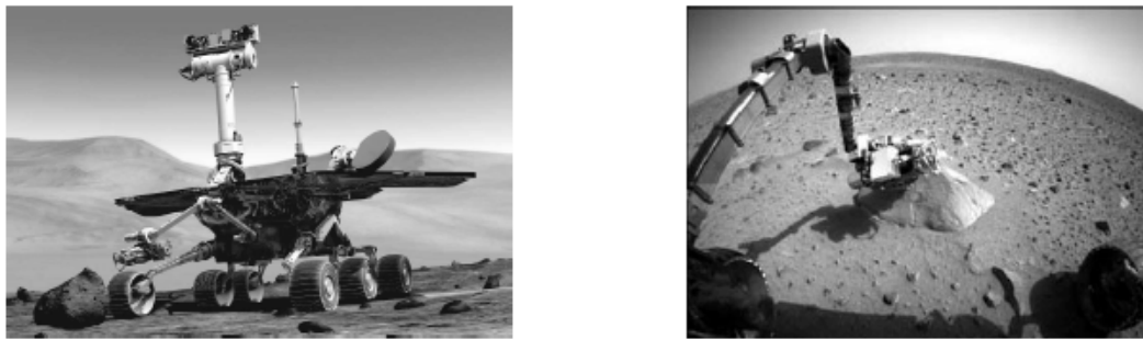
FIGURE 1 – Représentation d'artiste du robot Spirit (à gauche) et prise de vue de la cible depuis la caméra panoramique implantée sur la tête périscopique (à droite)
