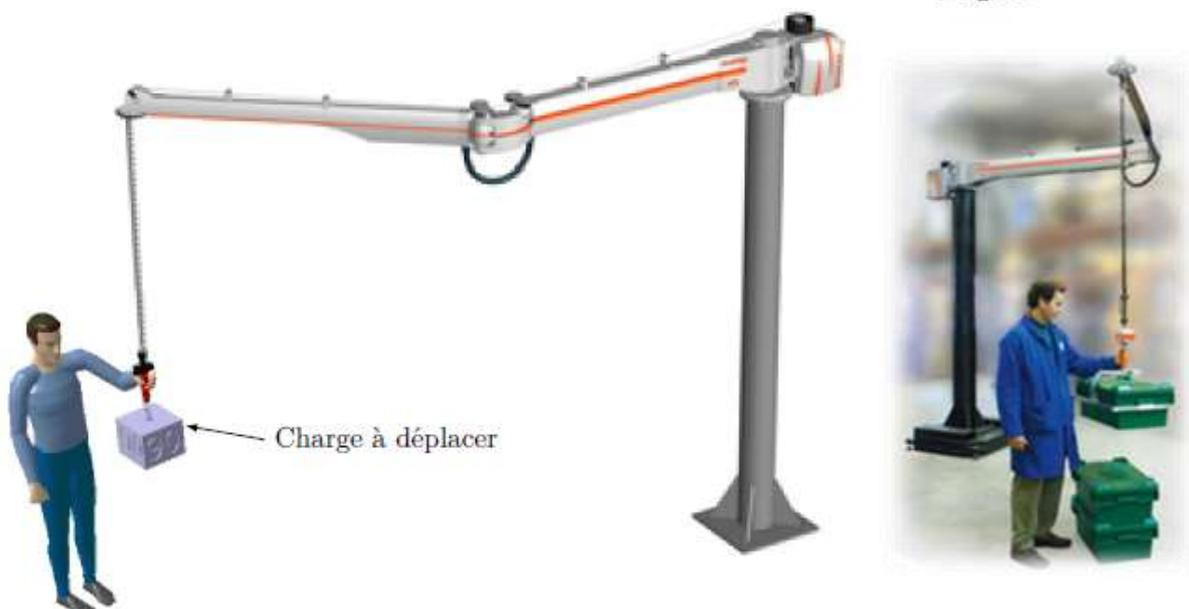
**Figure 1** : illustrations du bras manipulateur collaboratif SAPELEM et d'un environnement de manutention
