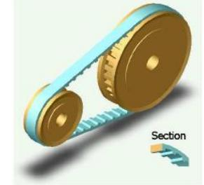
Du fait de l'inextensibilité de la courroie, les vitesses de tous ses points ont la même norme. Si la courroie ne glisse pas sur les poulies, alors on en déduit que le rapport de réduction :
