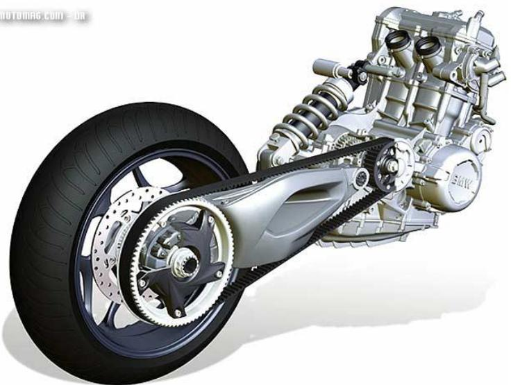
Transmission par courroie crantée d'une moto
