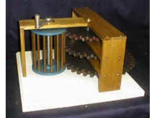
Les engrenages servent principalement à la transmission d'efforts et de mouvement de rotation lorsqu'il est nécessaire de réaliser une transformation spatiale de l'arbre de rotation : transmission de puissance ( $P = C \times \omega$ ) en augmentant ou en diminuant la vitesse de rotation ; permet également d'augmenter ou de diminuer le couple transmis.
