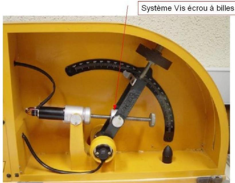
Le système vis/écrou permet de transformer un mouvement de rotation de la vis en mouvement de translation de l'écrou. Il s'agit d'un système vis écrou classique avec interposition d'éléments roulants pour éliminer les frottements. Lors du mouvement, les billes se déplacent dans un circuit fermé.
