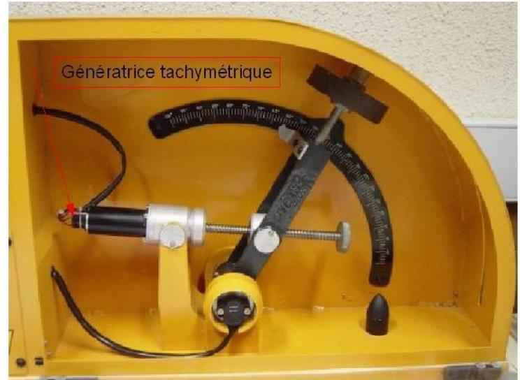
Ce capteur fonctionne comme un moteur électrique à courant continu (voir l'annexe sur les moteurs électriques), mais en sens inverse : la tension qu'il délivre est proportionnelle à sa vitesse de rotation. La démonstration de ce résultat s'obtient en regardant les équations du moteur à courant continu, pour une résistance et une inductance négligeables.
