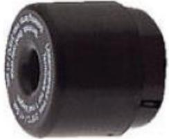
Cette génératrice à faible inertie avec commutation en métaux précieux est l'accessoire indispensable pour l'affichage ou la recopie de la vitesse dans une boucle d'asservissement. A préférer à l'utilisation d'un codeur dans des applications motorisées à basse vitesse, cette génératrice ne peut être associée aux moteurs RED25CLL, RED25G et RED35G que lors de la fabrication.
