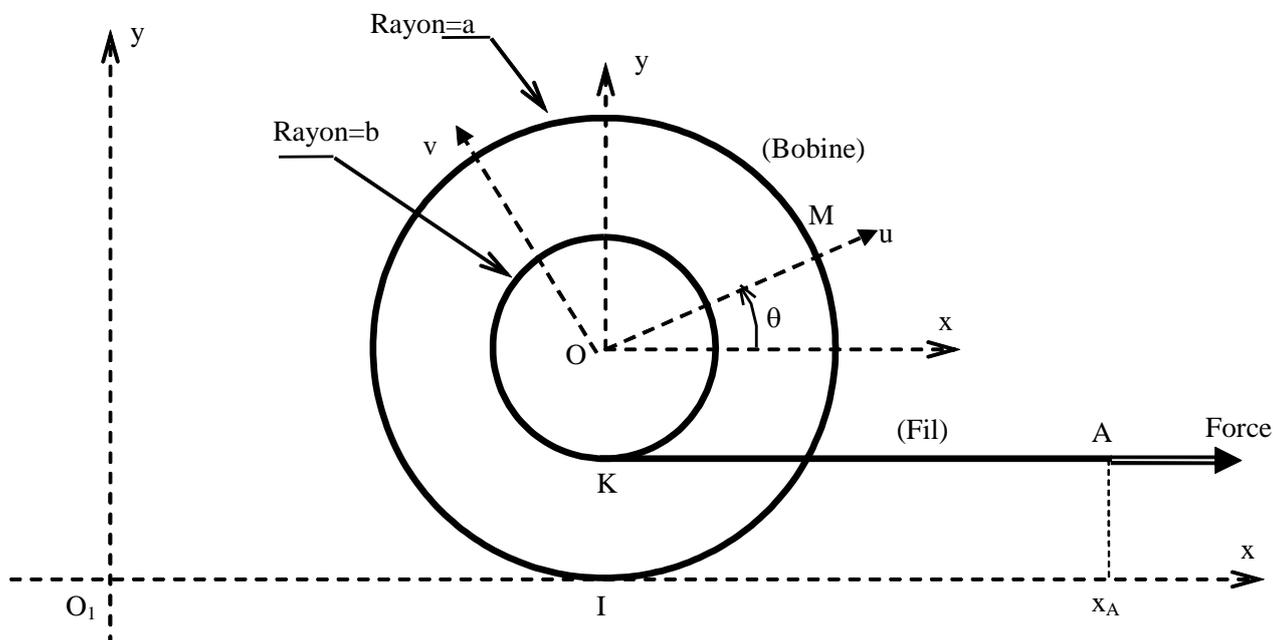
Soit une bobine de fil (B) représentée par la figure ci-jointe dans son plan de symétrie  $(O, \bar{x}, \bar{y})$ . On désigne par  $a$  le rayon du grand cylindre de la bobine et par  $b$  le rayon du petit cylindre sur lequel est entouré un fil (F) inextensible.
