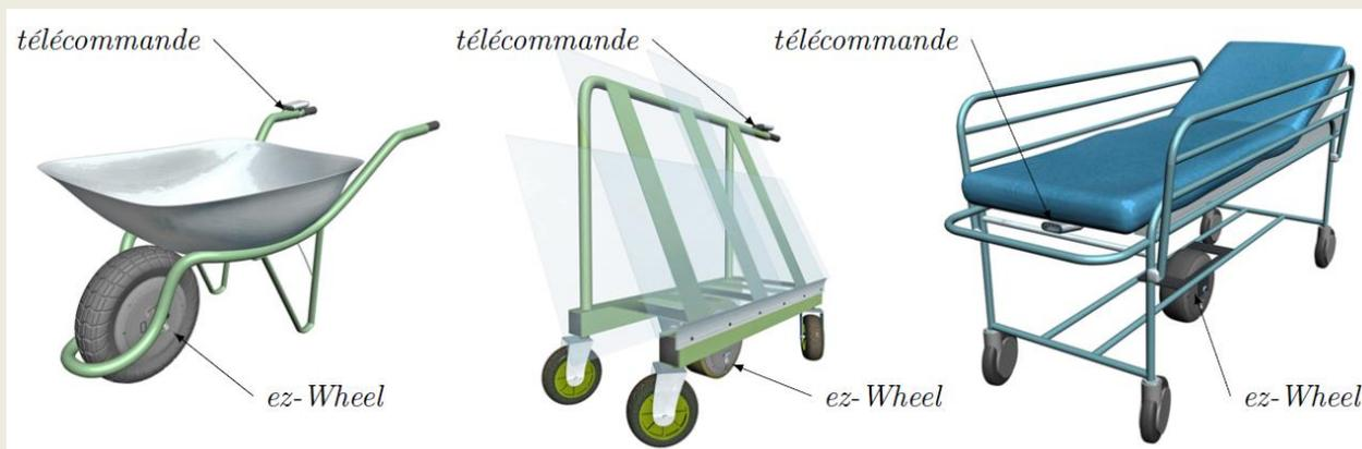
La solution intègre, au sein d'une roue, tous les composants nécessaires à la traction : la motorisation électrique, des batteries haute énergie de très longue durée de vie, un contrôleur de puissance assurant un pilotage optimal et la gestion de la batterie ainsi qu'une interface de commande sans fil. La transmission de l'énergie est réalisée par un variateur (incorporé à la carte de commande), un moteur brushless, puis un réducteur.
