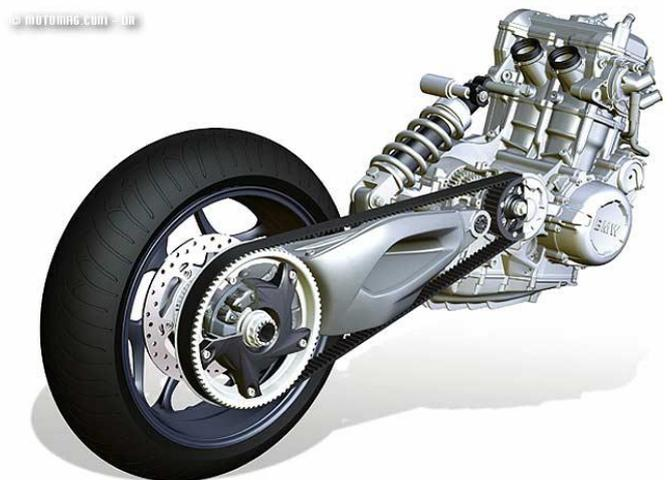
Transmission par courroie crantée d'une moto
