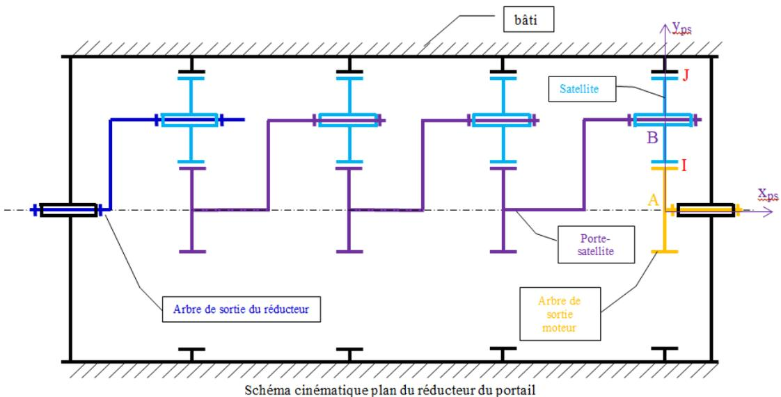
Les nombres de dents des différentes roues dentées sont :  $Z_{\text{arbre sortie moteur}} = 9$  ;  $Z_{\text{satellite}} = 18$  ;  $Z_{\text{couronne bâti}} = 45$
