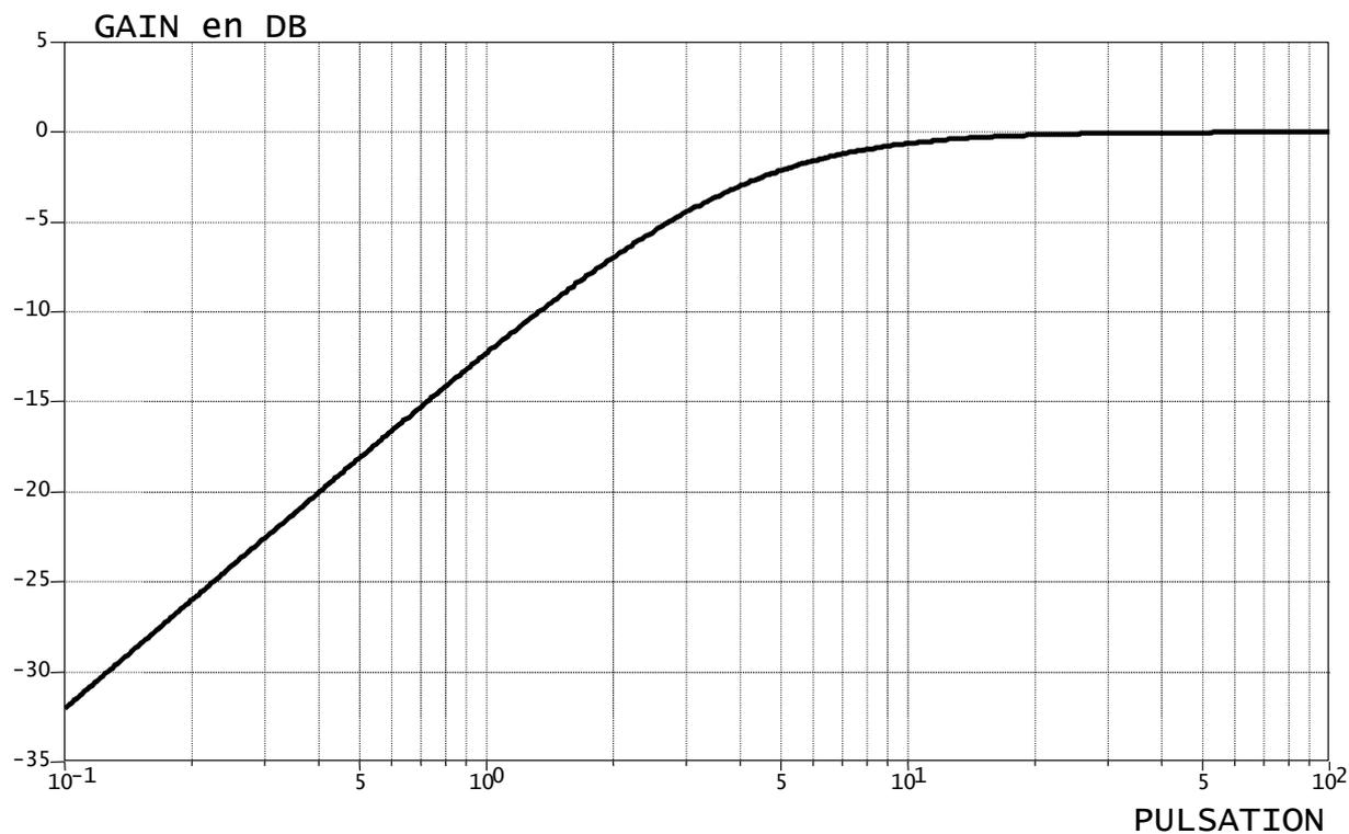
Diagramme de gain associé à la fonction de transfert  $F_{ph}(j\omega)$
