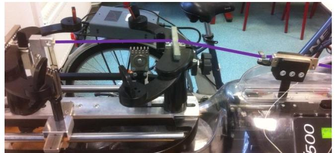
**Q10-** Pour une tension « aller-retour » de la corde (cf photo ci-contre), réaliser une mesure permettant d'estimer le coefficient d'adhérence entre la corde et les œillets.
