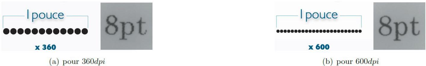
Figure 7 : illustration de la résolution d'impression
