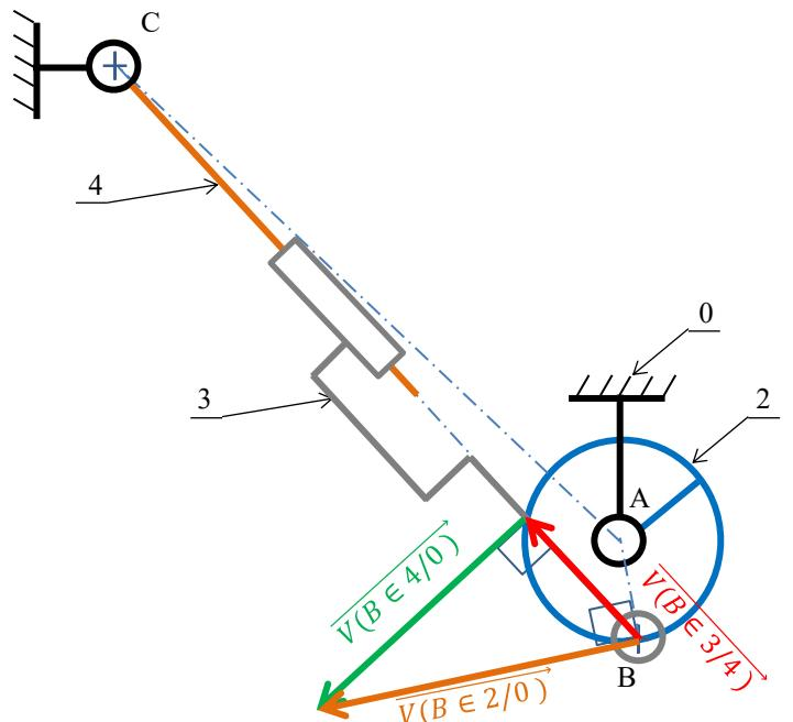
**Q16.**  $\overrightarrow{V(B \in 3/4)}$  est maximale si  $\overrightarrow{V(B \in 4/0)} = \vec{0}$
