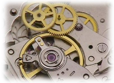
Train d'engrenages d'une montre
