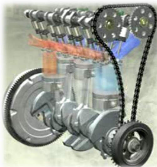
Chaîne reliant les deux arbres à cames d'un moteur de voiture
