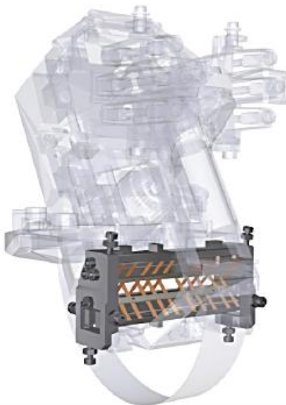
articulation à lamelles entre (1) et (2)
