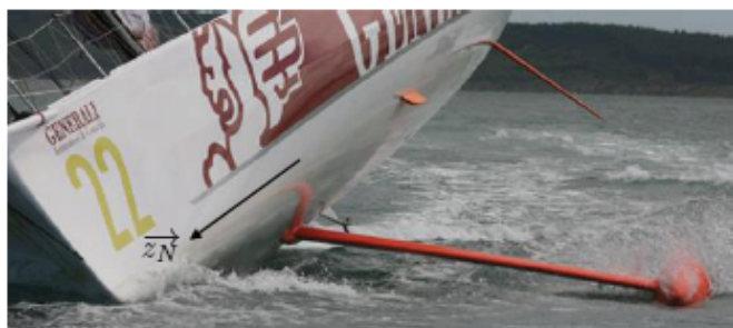
FIGURE 5 – Voilier avec sa quille pendulaire écartée au maximum sur « bâbord »
