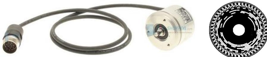
La roue codeuse ci-dessus, présente à l'intérieur du codeur, possède  $n = 12$  pistes concentriques (du centre vers la périphérie) qui vont permettre, par lecture optique (led + phototransistor), de déterminer  $2^n = 2^{12} = 4096$  positions angulaires de l'axe du codeur optique pour 1 tour de celui-ci.
