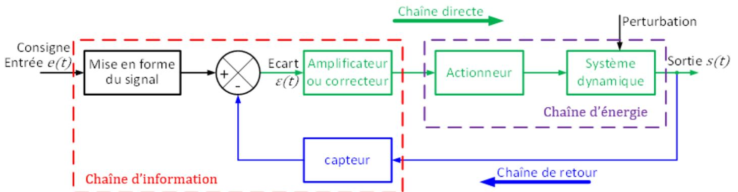
Figure 1 : Forme générale d'un schéma-bloc fonctionnel associé à un système automatisé asservi mécatronique
