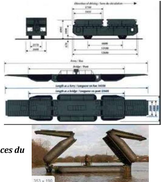
Plusieurs ponts flottants peuvent être accrochés en série pour constituer un pont de plus de 100 mètres de longueur. Chaque pont flottant est motorisé pour se déplacer dans les cours d'eau et contrer les courants.
