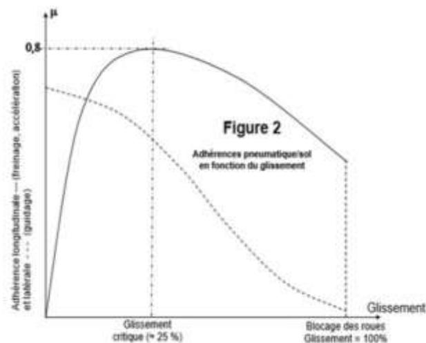
D'après Q2.4, on obtient  $\dot{\theta} = \frac{V}{R} \cdot (g - 1)$  et  $\dot{\theta}_{rsg} = -\frac{V}{R} \cdot (0,25 - 1)$ . Numériquement,  $\dot{\theta}_{rsg} = -\frac{25}{0,3} = -83$  rad/s.
