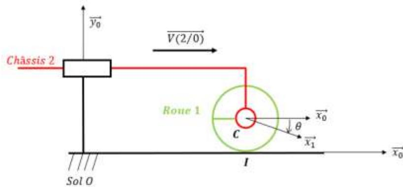
On définit le **glissement** relatif entre le pneumatique et le sol par  $g = \frac{\vec{V}(I \in 1/0) \cdot \vec{x}_0}{\vec{V}(2/0) \cdot \vec{x}_0}$ .
