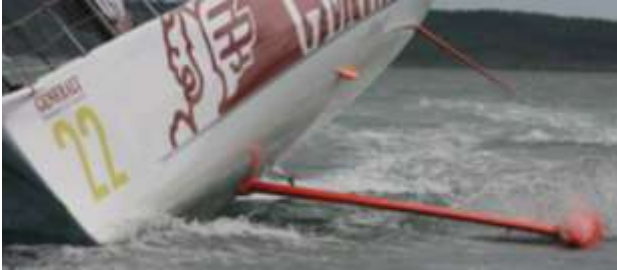
Figure 3 : Voilier avec sa quille pendulaire écartée au maximum sur « bâbord »
