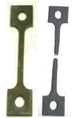
Figure 1 : Eprouvette avant et après essai
