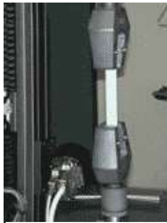
Figure 3 : Eprouvette dans les mors de la machine.
