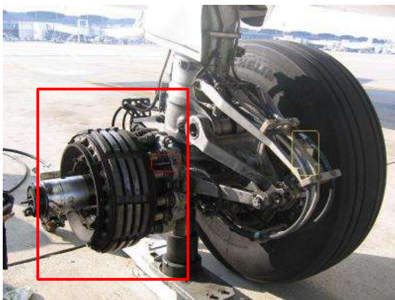
Bloc de freinage de l’A320 ouvert (à gauche) et modèle associé (à droite)
