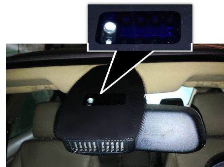
FIGURE 2 – Principe de fonctionnement d'un détecteur de pluie
