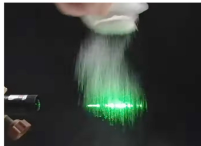
FIGURE 4 – Goutellettes d'eau d'un brumisateurs (à gauche) et farine (à droite) sur le passage d'un rayon LASER
