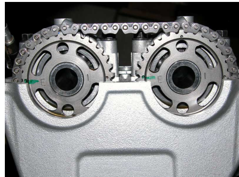
Chaîne reliant deux arbres à cames
